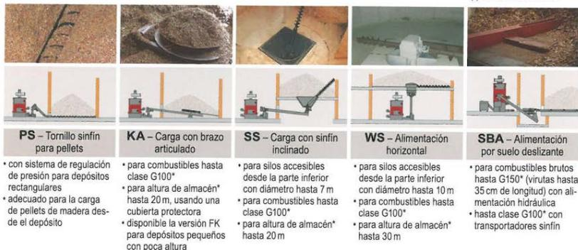
\*)...Todas las indicaciones de tamaño de combustible y altura de almacenamiento en silo son valores indicativos que dependen de la versión y del tipo de combustible. Atención: en descargas mayor de 2 veces el diámetro del depósito puede producirse un atochamiento.
