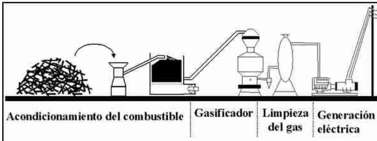
Como ocurre con la combustión, existen diferentes tecnologías de gasificación de un recurso, gasificador de corrientes paralelas, gasificador en contracorriente, gasificador de lecho fluido, etc. En función de las características del combustible y del destino del gas generado es más conveniente un tipo de aplicación u otro.
