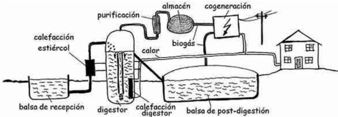
El biogás, cuyos componentes principales son el metano y el anhídrido carbónico, puede emplearse para producir energía térmica, eléctrica o en sistemas de cogeneración. El metano es el componente que confiere el valor energético a este gas, 1 m<sup>3</sup> de biogás con un 60% de metano tiene un poder calorífico próximo a las 5.500 kcal.
