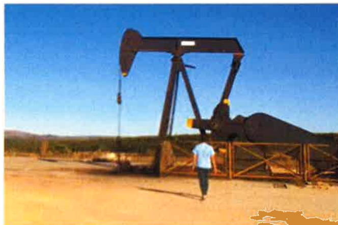
Figura 8: Sistema de extracción del crudo denominado caballito o péndulo
