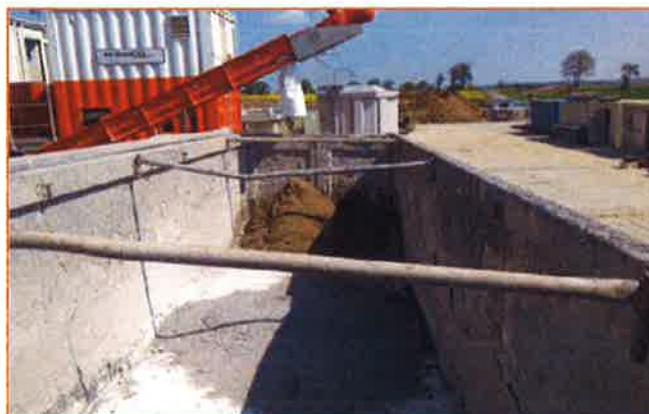
Cribas vibratorias separando lodos y rípios. Fuente BNK Contenedor de almacenamiento de rípios y detalle de criba vibratoria
