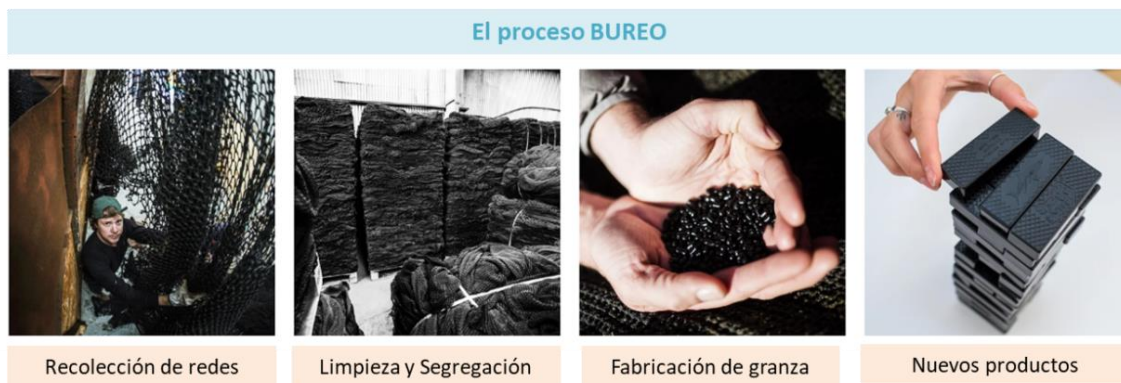
Figura 43. Proceso de fabricación de la empresa Bureo partiendo de redes de pesca Fuente: https://bureo.co/
