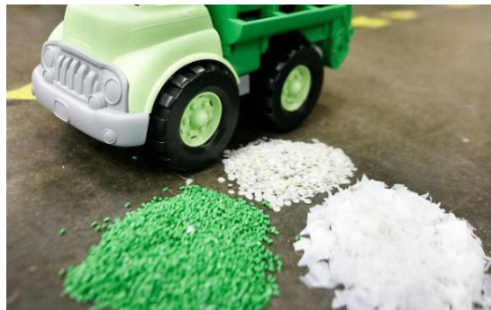
Figura 50. Proceso de fabricación de juguetes partiendo de granza de rLDPE y Rpp Fuente: https://www.greentoys.com
