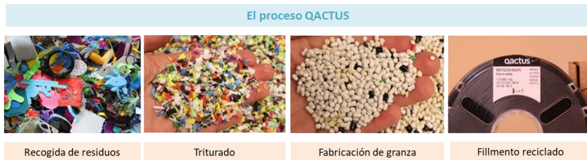
Figura 46. Proceso de fabricación de filamento de material reciclado www.QACTUS.cl
